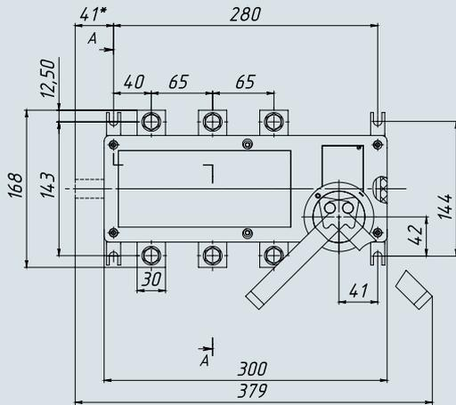
Отверстия в оболочке для установки аппарата на одно направление
