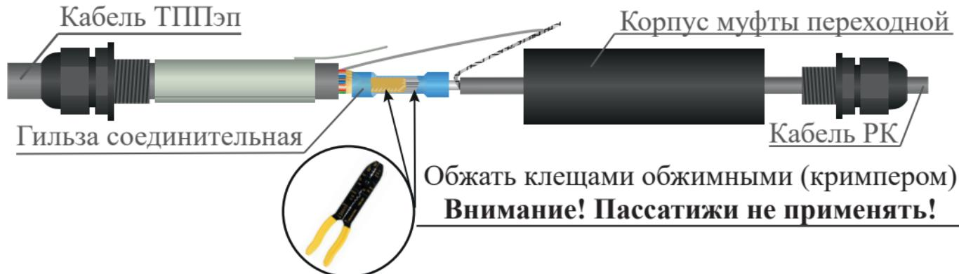
Направление укладки экранного проводника и экранной оплетки
