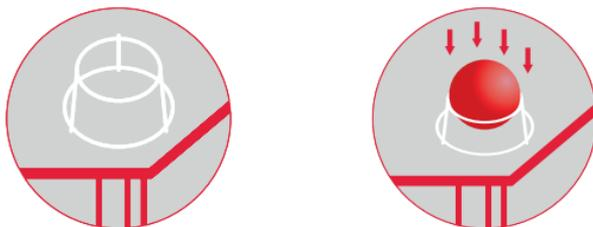
Для размещения в ручном режиме универсальное крепление используется как подставка, которая располагается большим диаметром окружности крепления вниз.
