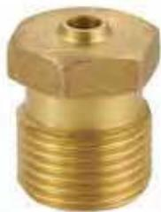
Клапан изготовлен из материалов, не подверженных коррозии: латунь и нержавеющей сталь. Применяется для автоматического слива воды из трубопровода. Клапан открывает сливное отверстие при снижении давления в магистрали до 0,6–0,7 атм и закрывает отверстие при повышении давления до 1,5 атм.
