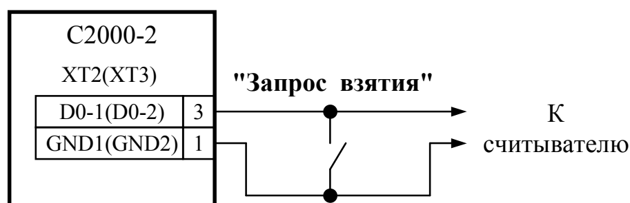
Рисунок 7 Подключение кнопки "Запрос взятия"
